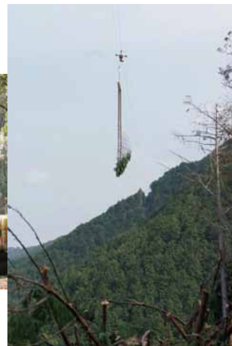
森の尾根と尾根にワイヤーを張り滑車を使って集積基地に伐採した間伐材を集める
